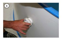
Die zweite Dichtung von außen aufsetzen und dann mit der Kontermutter festziehen
