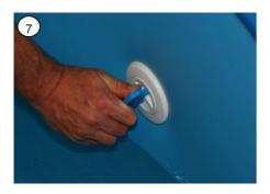
Die Einlaufdüse mit Hilfe der Winterverschlußkappe verschliesen. Mit dem Schlüssel können Sie die Kappe fest drehen.
