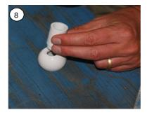
Mit Hilfe des Stanzstift (11) kann das Loch der Richtungskugel vergrößert werden. Schlagen Sie mit einem Gummihammer auf den Stift um das Innere der Kugel herauszubrechen.
