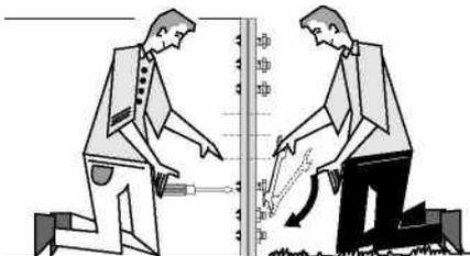
Alle Schrauben mit einem Schraubenzieher und einem Schlüssel festziehen. Hierzu sind 2 Personen erforderlich.
